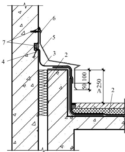
图 5.4.3.44-2 高低跨变形缝渗漏维修
