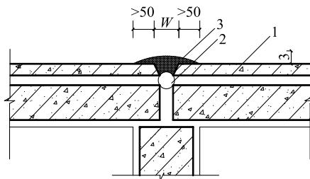
图 5.4.3.30-1 分格缝处采用密封材料嵌缝维修
