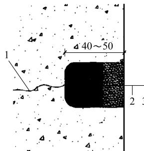
图 5.7.3-3 裂缝快速封堵止水
