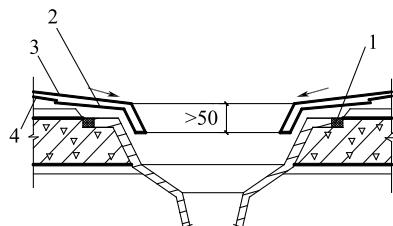
图 5.4.3.17 直式落水口与基层接触处渗漏维修
