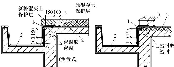
图 5.4.3.15 天沟、檐沟与屋面交接处渗漏维修
