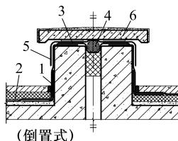
图 5.4.3.44-1 水平变形缝渗漏维修
