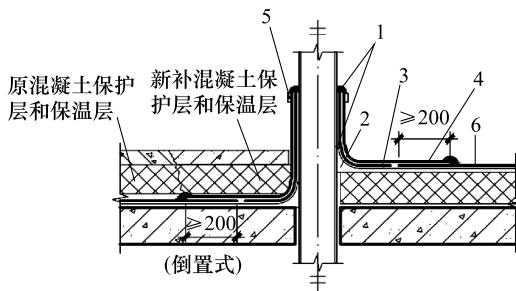
图 5.4.3.18 伸出屋面管道根部渗漏维修
