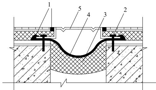
图5.5.3.18 墙体变形缝渗漏维修
