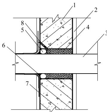
图 5.5.3.20-2 穿墙管根部渗漏维修（外）
