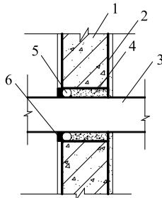
图 5.5.3.20-1 穿墙管根部渗漏维修（内）
