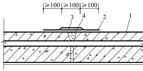
图5.4.3.32 刚性混凝土防水层宽裂缝渗漏维修
