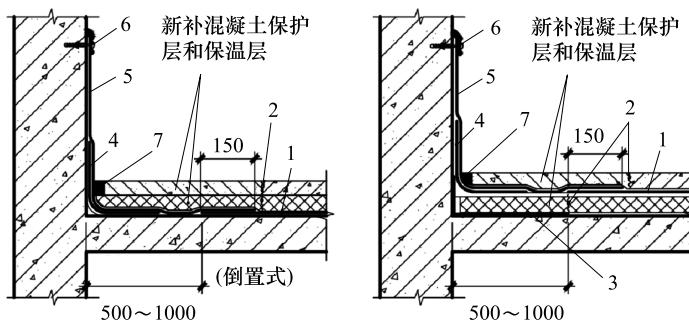
图 5.4.3.29-2 泛水根部结构渗漏维修
