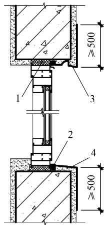
图 5.5.3.25 窗框边渗漏维修
