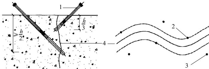
图 5.7.3-2 钻孔注浆止水及补强的布孔
