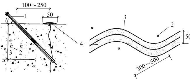
图 5.7.3-1 钻孔注浆布孔
