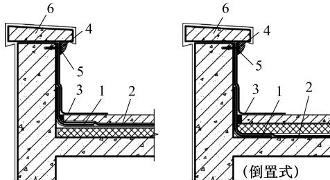
图 5.4.3.29-1 泛水防水层收头维修
