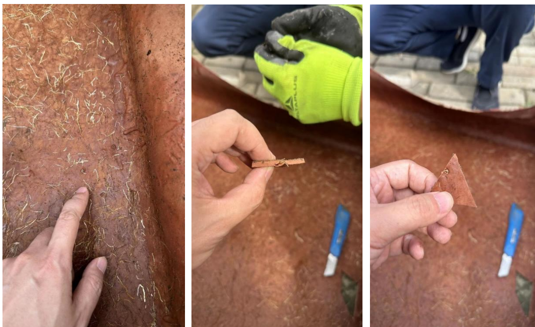
图2 一个样品有一个根穿刺点
