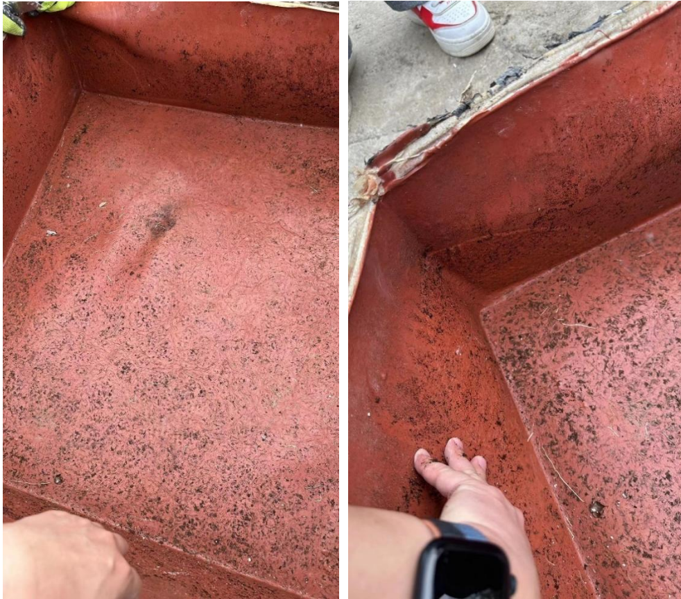
图 3 另一个样品一年期开箱完好，无根穿刺现象
